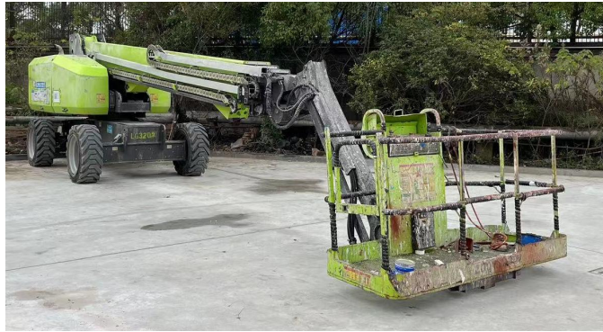
图2 直臂式高空作业平台（车）
