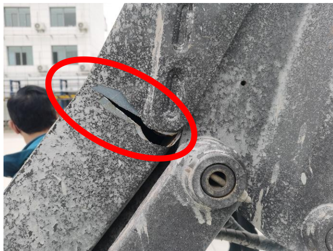
图3 作业斗飞臂断裂点
