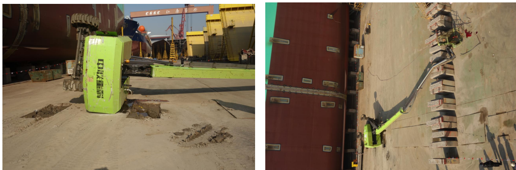
图3 侧翻车辆状态示意图
